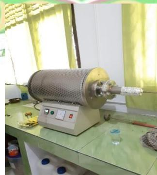
Dikarbonisasi menggunakan *furnace*  $\text{N}_2$  pada suhu  $800^\circ\text{C}$  secara bertingkat dengan laju pemanasan  $5^\circ\text{C}/\text{menit}$
