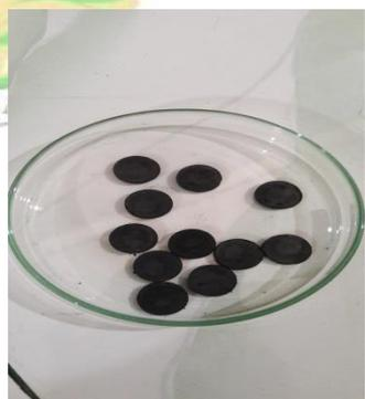
Pelet elektroda karbon aktif setelah karbonisasi, dicuci menggunakan aquades hingga pH netral dan dikeringkan dalam oven
