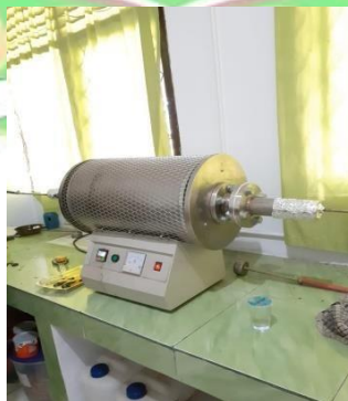
Dikarbonisasi menggunakan furnace \text{N}_2 pada suhu 800^\circ\text{C} secara bertingkat dengan laju pemanasan 5^\circ\text{C}/\text{menit}
