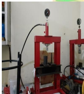
Ditimbang 0.7 g sampel, dicetak membentuk pelet menggunakan hidroullic press pada tekanan 8 ton dan diukur diameter serta ketebalannya
