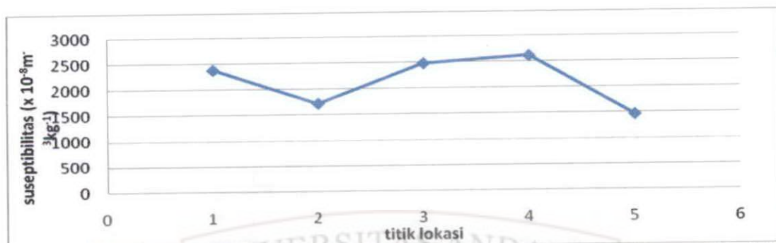
Gambar 4.1 Grafik suseptibilitas pasir besi di lima titik lokasi dengan jarak antar titik adalah 50 m.
