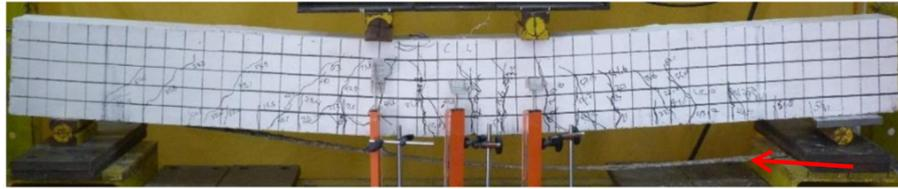
**Gambar 1.1 Keruntuhan debonding pada balok beton bertulang yang diperkuat pelat CFRP (Thamrin dkk., 2021)**
