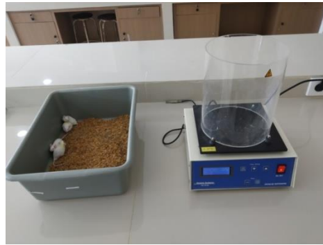
Gambar 18. Instrumen untuk Pengujian Aktivitas Analgetik ( Hot Plate ).
