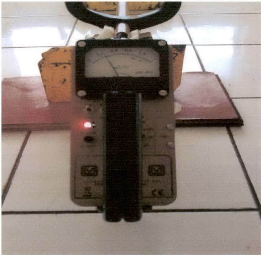
Gambar 8. Lampu pada detektor menyala karena ada radiasi gamma yang di tangkap
