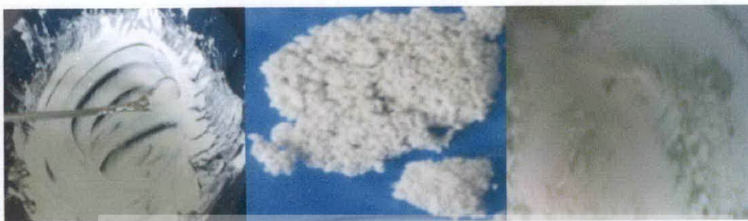
Gambar 4.2 Hasil penggerusan sampel BKT (a) percobaan pertama bahan berbentuk pasta/cream (b) percobaan kedua, bahan berbentuk gumpalan, dan (c) percobaan ketiga bahan berbentuk serbuk.
