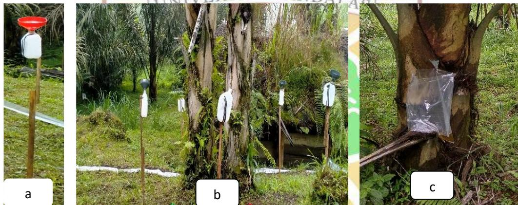
Gambar 3. (a) Ombrometer manual, (b) Pengukuran air lolos tajuk tanaman dan (c) Pengukuran aliran batang
