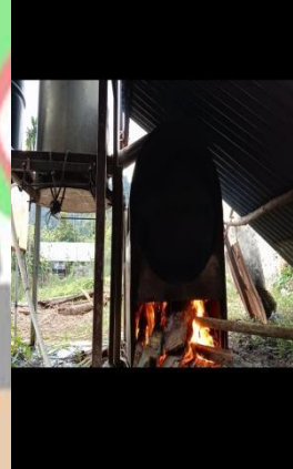
Proses penyulingan menggunakan kayu bakar
