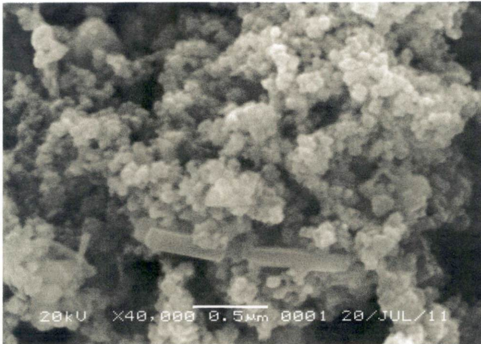
Gambar 4.9 Bentuk morfologi \text{Fe}_3\text{O}_4 hasil sintering pada temperatur 700^\circ\text{C}
