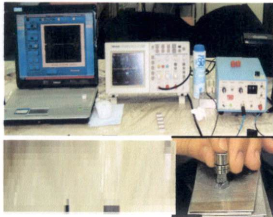
Gambar 2.3. Metode Pengujian Kontak Langsung (sumber:Labor NDT PTRKN-BATAN)
