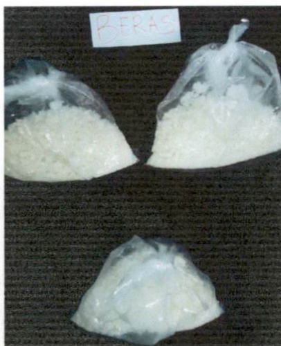
Gambar 2. Media beras yang sudah disterilkan dalam autoclave
