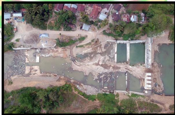
Gambar 1.2 Bangunan Pengendali Sedimen Lama
