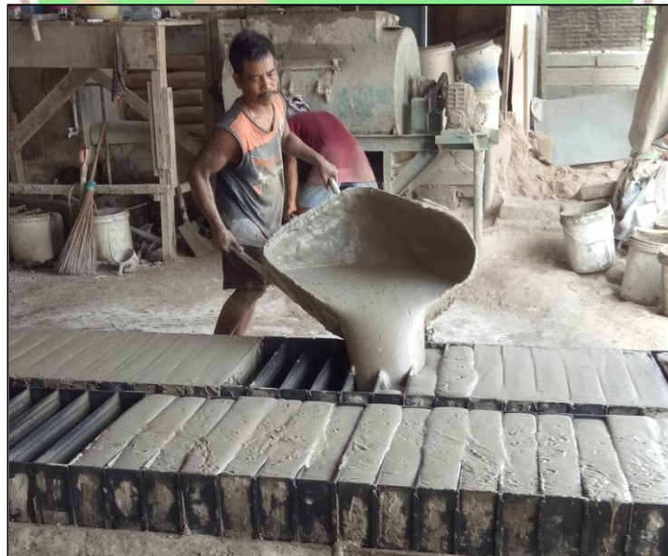
Gambar 1.3 Proses Pencetakan Beton Ringan
