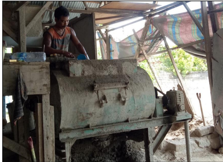
Gambar 1.2 Proses Pengadukan Bahan Dasar
