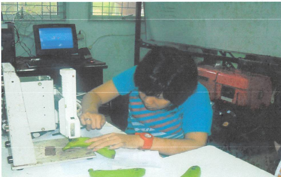
Pengambilan data kekerasan dengan menggunakan Force Gauge
