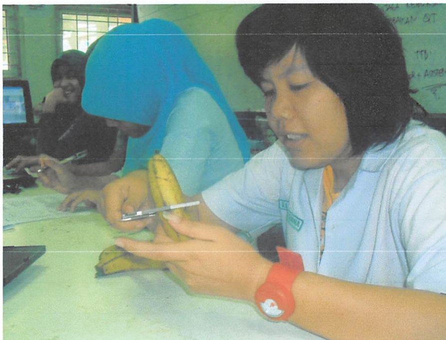
Pengambilan data diameter menggunakan jangka sorong
