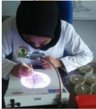
Proses Perhitungan Jumlah Koloni menggunakan Colony Counter
