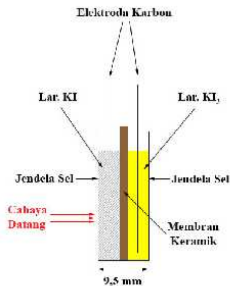
Gambar 14. Skema sel fotovoltaik
