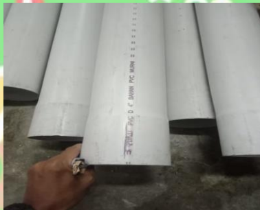
Gambar 17. Pipa untuk Bekisting
