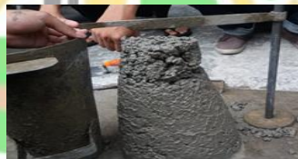
7 Gambar 4.1 Proses Pengujian Slump Beton
