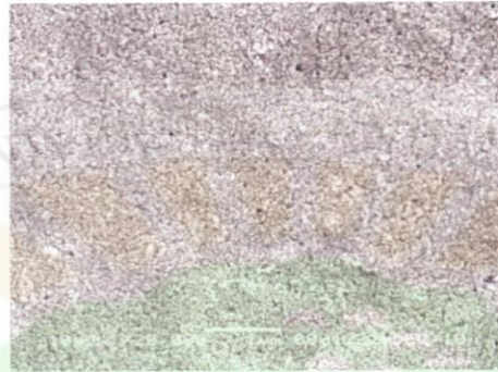
Gambar 14. Foto SEM permukaan lapisan tipis kalsium fosfat dengan \text{Ca}(\text{NO}_3)_2 \cdot 4\text{H}_2\text{O} sebagai prekursor pada perbandingan molar Ca/P 1,80
