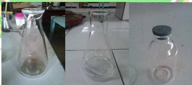
Gambar 3.10 Tabung *Filtering flask* (kiri), tabung *Erlenmeyer* (tengah), tabung *vial* (kanan).
