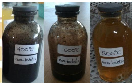
**Gambar 4.6** Kondensat hasil gasifikasi tanpa menggunakan katalis.
