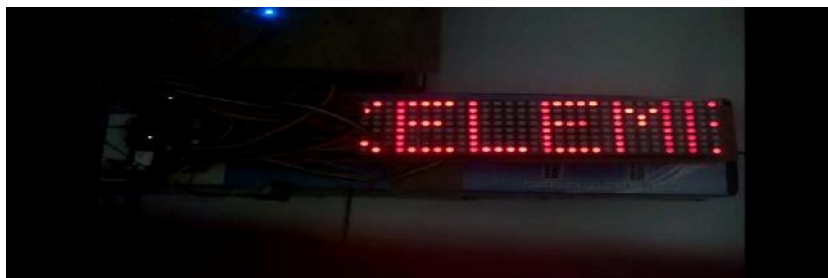
Gambar 4.3 Tampilan Kelembaban pada Dot Matrix
