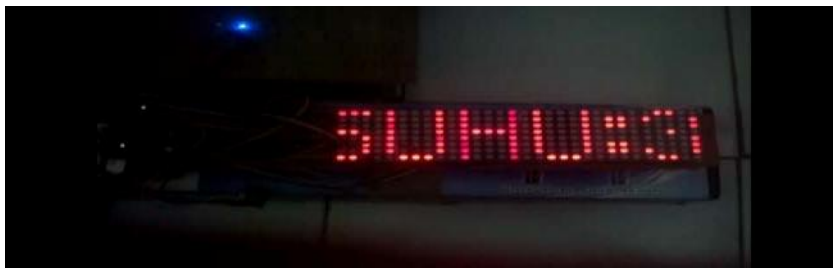
Gambar 4.2 Tampilan Suhu pada Dot Matrix
