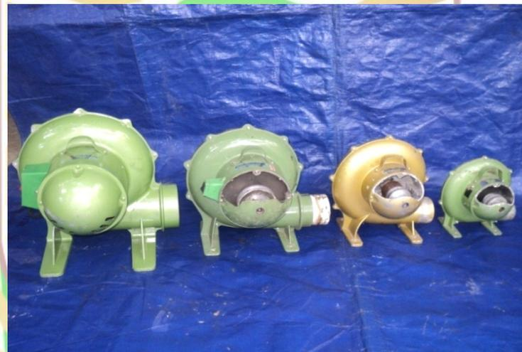
Gambar 8. Blower Sentrifugal Ukuran 4 inchi, 3 inchi, 2,5 inchi dan 2 inchi yang Akan Diuji Labor sebagai Turbin Air, Tampak Blower 4 inchi Masih Orisinil atau Belum Mengalami Modifikasi
