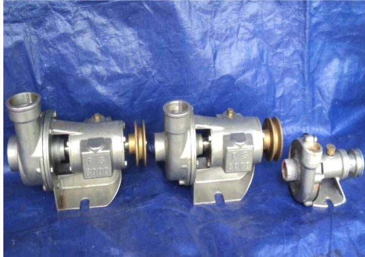
Gambar 7. Pompa Sentrifugal Tipe PS 8000 Ukuran 2 inchi, 1,5 inchi dan 1 inchi yang Diuji Labor sebagai Turbin Air
