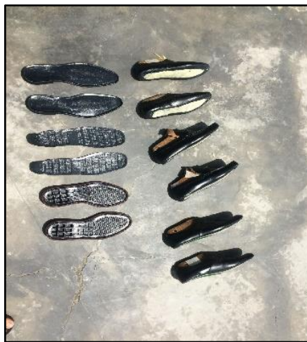
Gambar 1.5 Metode Pengeringan dengan Bantuan Cahaya Matahari Langsung (Sumber: IKM Bebels Footwear)
