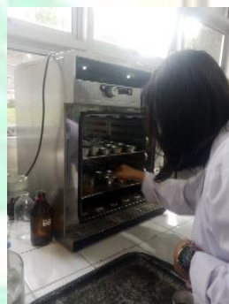
Gambar 6. Uji kadar air di oven
