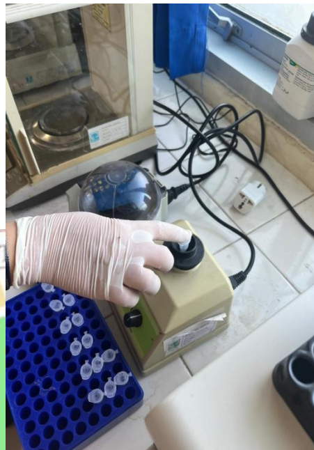
Gambar 29: Proses vortex untuk menghomogenkan sampel
