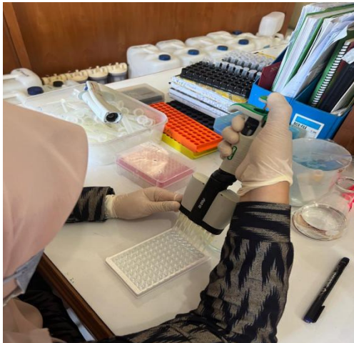
Gambar 36 : penyiraman dengan aquades dan wash buffer
