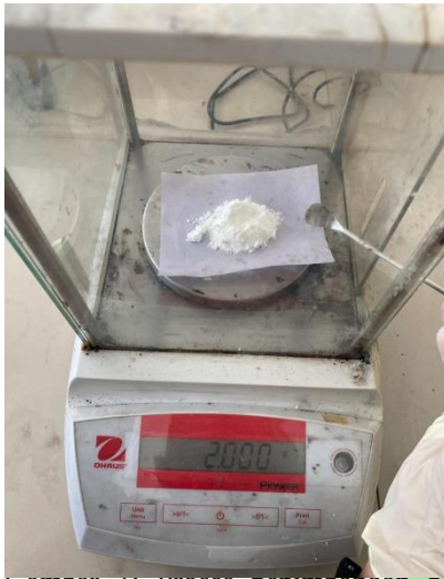
Gambar 1: Proses penimbangan bahan dengan timbangan analitik
