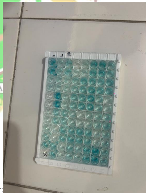
Gambar 51: well IL-10 setelah dimasukkan Streptavidin hrp
