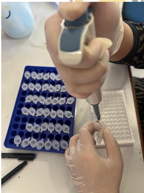
Gambar 30: memasukkan sampel kedalam well
