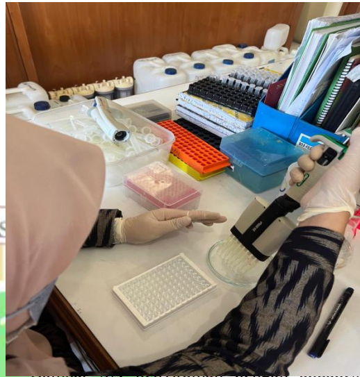
Gambar 37 : penyiraman dengan aquades dan wash buffer
