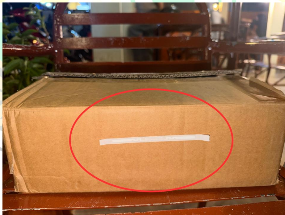
Gambar 4.6 Pemasangan Tag Label RFID
