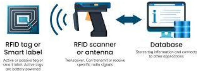
Gambar 1.11 Cara kerja RFID
