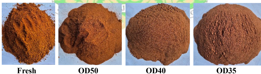
Gambar 4.4 Karakteristik Warna dan Tesktur Kulit Manggis Hasil Pengeringan
