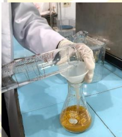
Penambahan HCL 0,1 N yang telah dilarutkan kedalam 150 ml aquades
