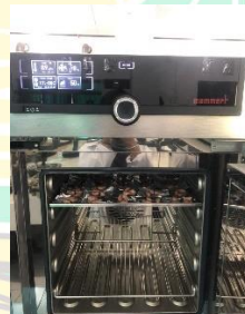
Pengovenan benih kakao untuk pengujian kadar air benih pada suhu 105°C selama 17 jam.
