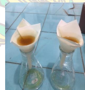
Endapan kemudian disaring dengan kertas saring dan dicuci dengan alcohol 98%
