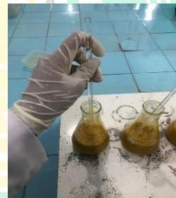
Melakukan ekstraksi dengan dipanaskan pada suhu 80°C selama 2 jam
