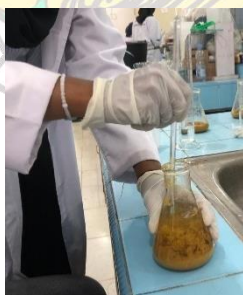
Penambahan alcohol 98% sebanyak 150 ml pada hasil ekstraksi
