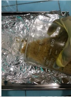
Endapan pektin kemudian dioven dengan suhu 40°C selama 8 jam
