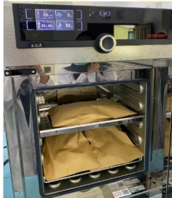
Pengovenan kulit jeruk manis dengan suhu 55°C selama 48 jam
