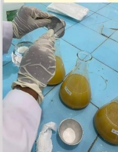
Pemberian 1 gram CMC dan dipanaskan dengan suhu 40°C selama 15 menit
