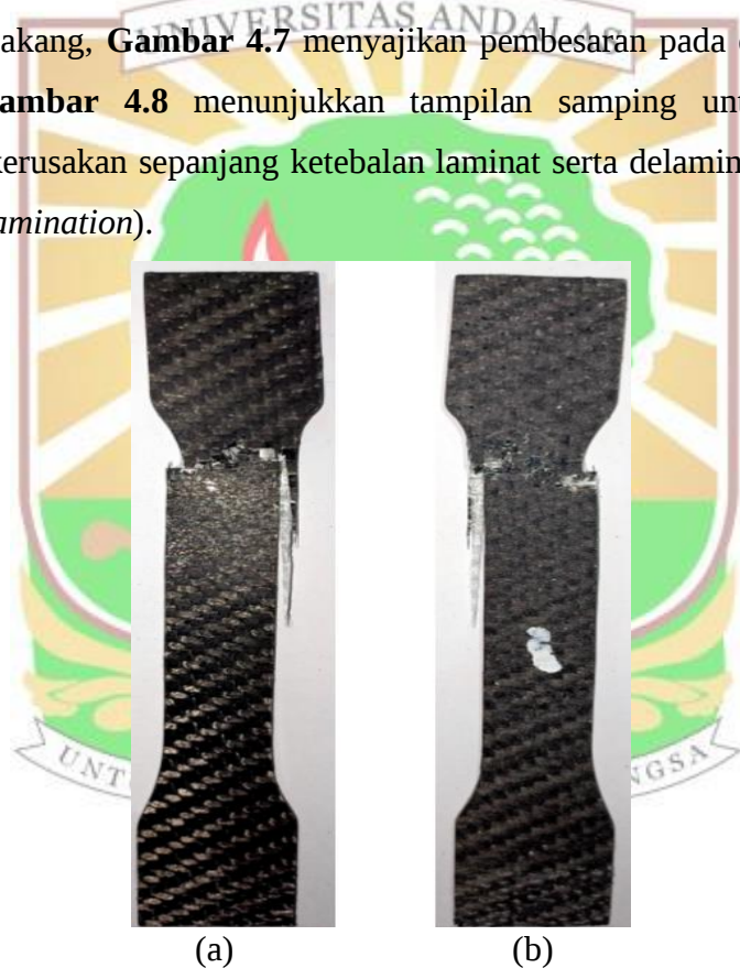
Gambar 4.6. Tampilan makroskopik keseluruhan spesimen representatif laminat hibrida 1 setelah pengujian tarik: (a) tampak depan dan (b) tampak belakang.
