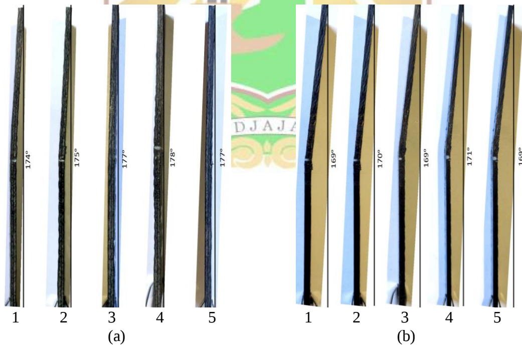
Gambar 4.14. Perbandingan tampak samping spesimen hasil uji lentur: (a) laminat hibrida dan (b) laminat CFRP.
