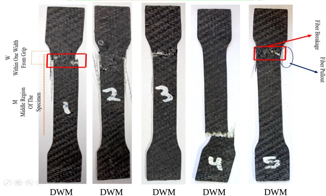
Gambar 4.11. Klasifikasi mode kegagalan ASTM D3039 pada spesimen uji tarik laminat hibrida.
