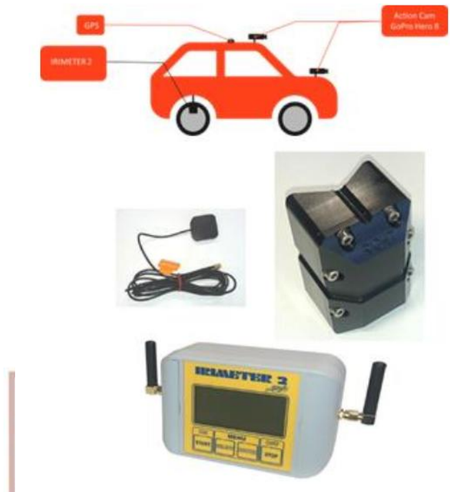
Gambar 2. 1 Alat yang akan digunakan pada Survei IRI (IRIMETER 2)
