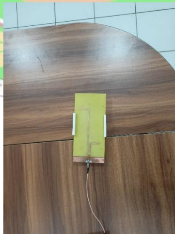
Gambar 4.15 Kondisi Isolasi Antena Dari Interferensi Konduktif Lingkungan Sekitar Pada Saat Pengukuran.
