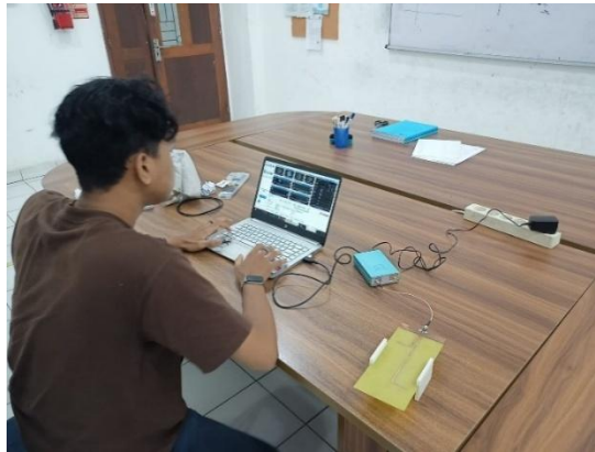
Gambar 4.14 Setup Pengujian Parameter S Menggunakan Vector Network Analyzer (VNA) Megiq 0440.
