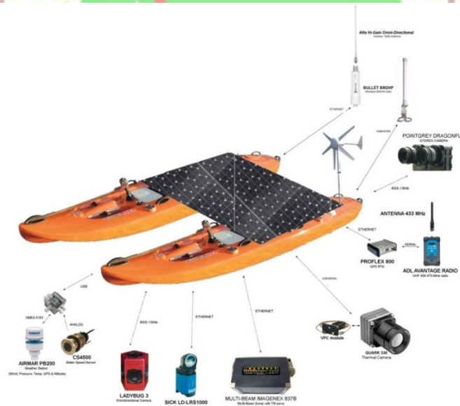
Gambar 2. 1 Diagram Umum Unmanned Surface Vehicle (USV) Beserta Komponen Pendukung Operasional [17].
