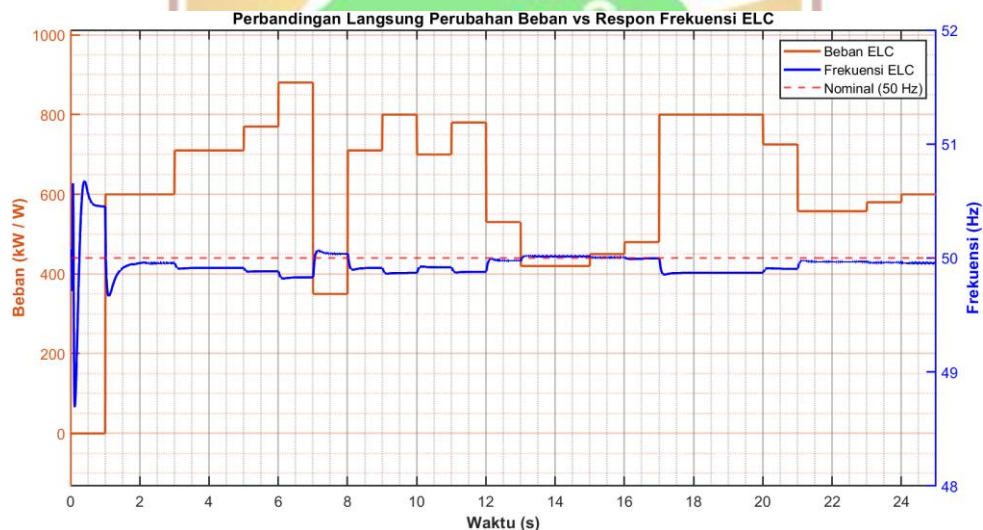
Gambar 4. 14 Perbandingan Beban Utama dan Frekuensi PLTP
