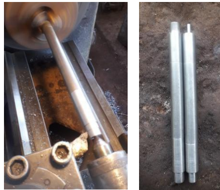
Gambar 4. 4 Proses dan Hasil Akhir Proses Pembubutan Poros.
