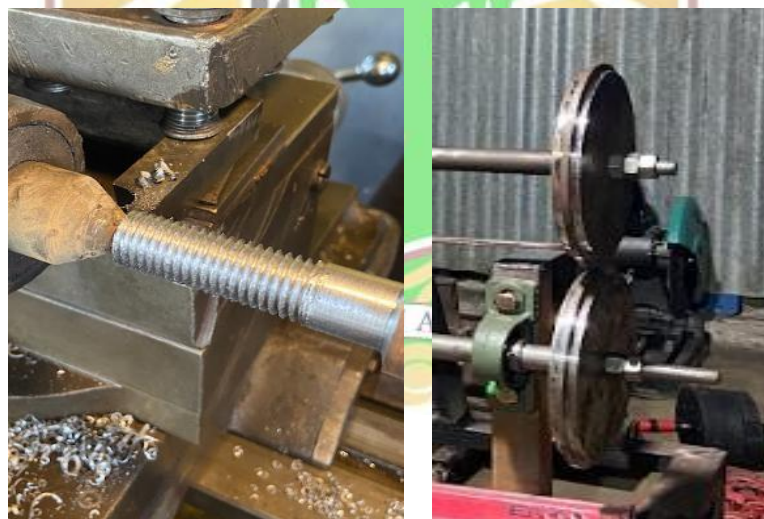
Gambar 4. 9 Pembuatan drag poros dan pemasangan disk uji.
