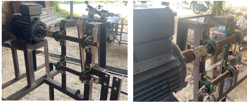
Gambar 4. 8 Motor Tersambung ke Poros Melalui Flexible Coupling .
