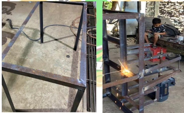
Gambar 4. 7 Proses Pemotongan dan Pengelasan Rangka Utama.
