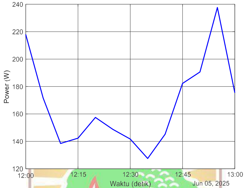
Gambar 4. 4 Daya keluaran panel surya selama satu jam.
