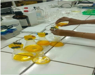
Proses penyaringan larutan CPO yang sudah di campur dengan n-heksan
