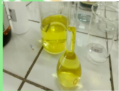
Larutan untuk menentukan DOBI dan karoten dengan 1gr CPO: 100 gr n-heksan
