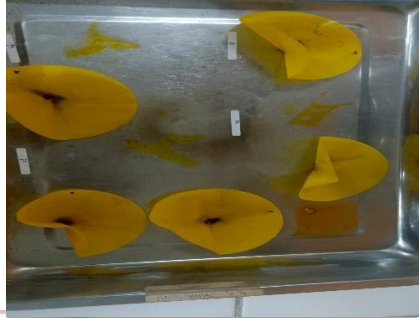
Kertas saring dan residu CPO yang telah dikeringkan
