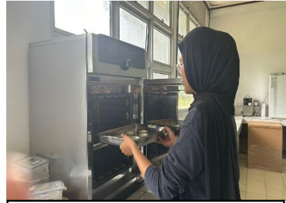
Penegriangan untuk kadar air dan kadar kotoran menggunakan oven
