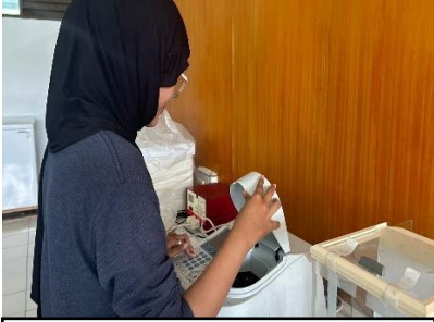
Proses menganalisis DOBI dan karoten menggunakan spektrofotometer UV-Vis
