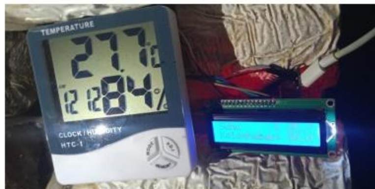
Gambar 4.1 Hasil Pengujian Alat menggunakan Hygrometer
