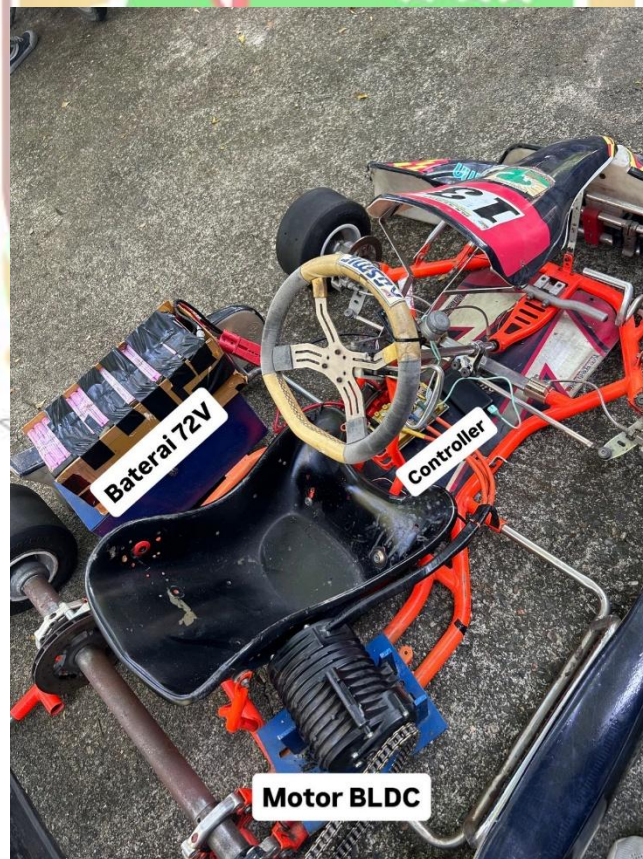
Gambar 4. 1 Sistem Penggerak Gokart Listrik
