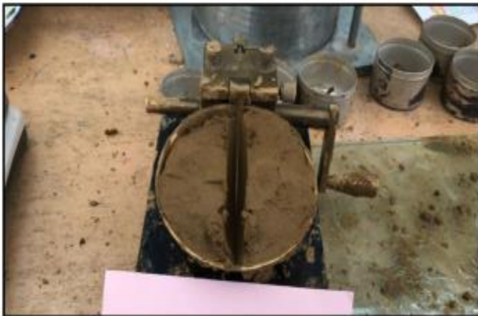
Gambar 4. 6 Dokumentasi Pengujian Liquid Limit
