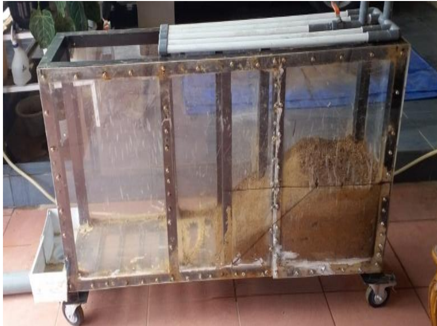
Gambar 3. 5 Dekomentasi pengujian besaran sudut lereng
