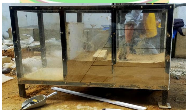
Gambar 4. 8 Pemadatan lapisan tanah dasar lereng
