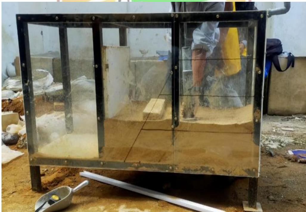
Lampiran 4 Pemadatan lereng pada model percobaan
