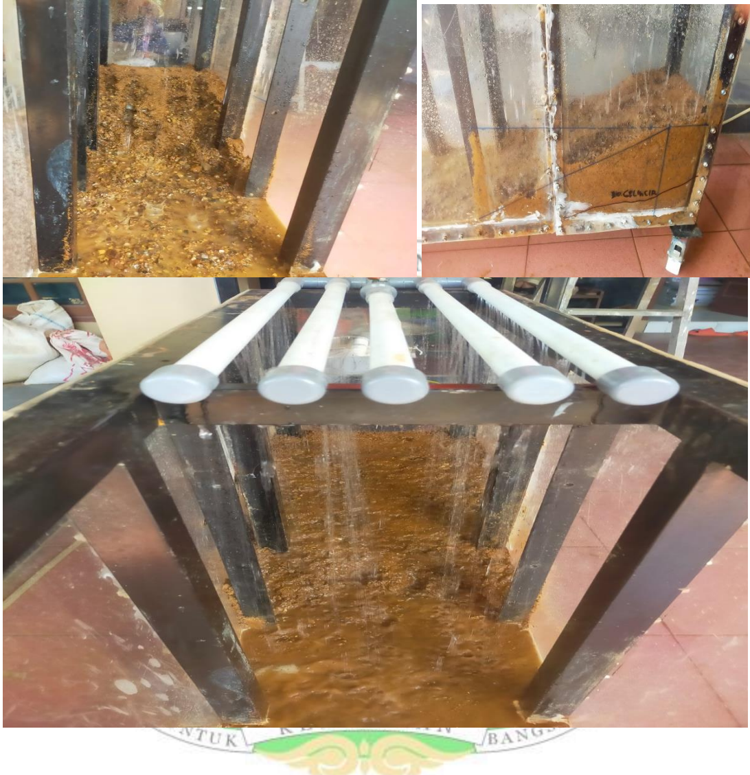
Gambar 4. 23 Dokumentasi bentuk lonsor aliran pada model percobaan
