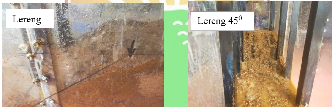
Lampiran 6 Dokumentasi percobaan keruntuhan untuk sudut lereng 45
