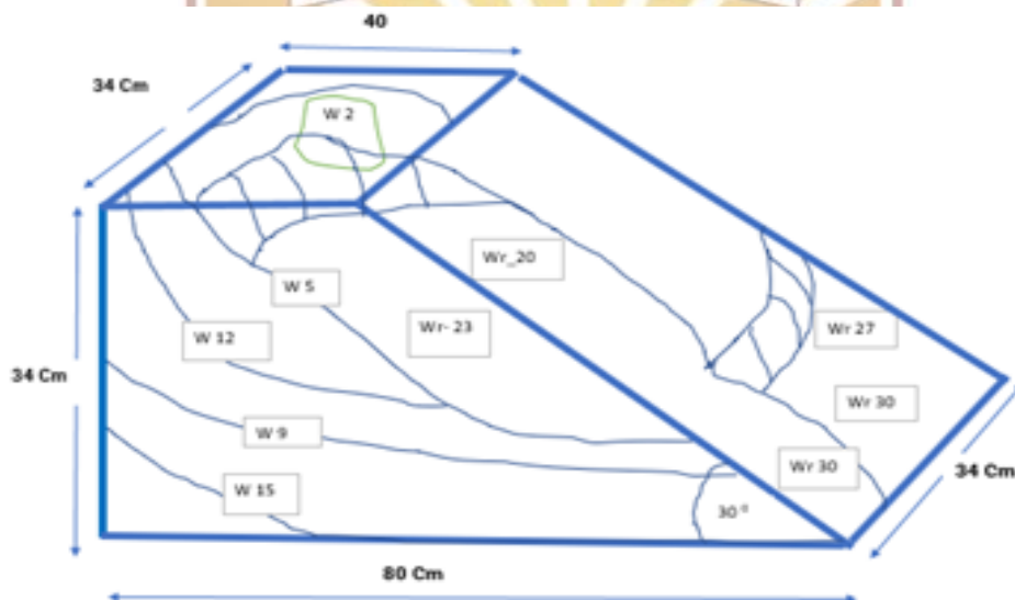
Gambar 4. 13 Bidang gelincir lereng sudut 30°
