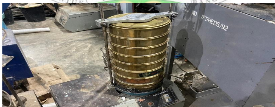
Gambar 4. 3 Pengujian Analisa saringan di labortorium
