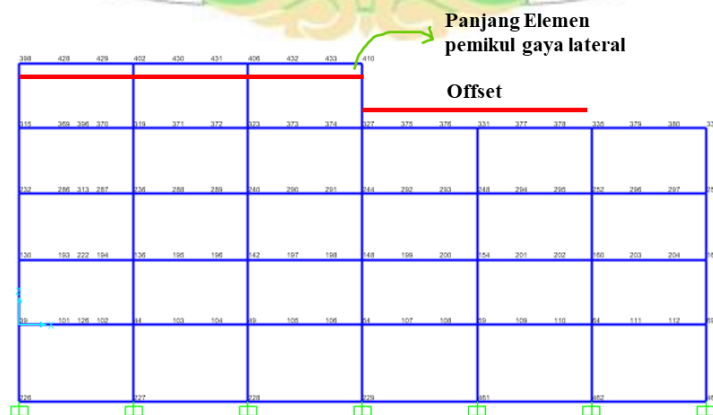
Gambar 4.26 Ketidakberaturan Arah Akibat Diskontinuitas Elemen Vertikal Pemikul Gaya Lateral
