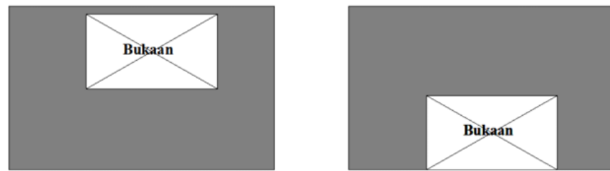
Gambar 4.18 Ketidakberaturan Horizontal : Diskontinuitas Diafragma
