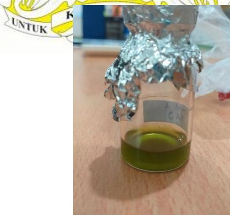
**Gambar 4.7** Biodiesel Hasil Transesterifikasi tanpa *Microwave*
