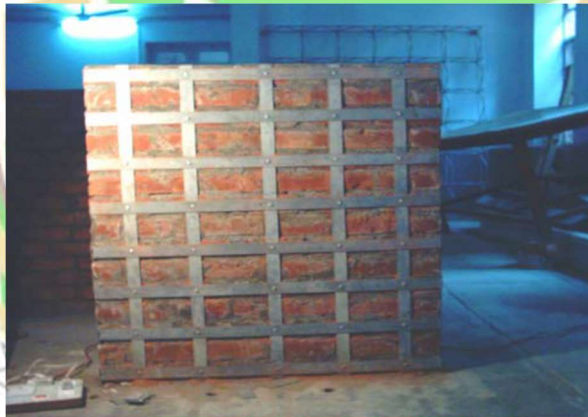
Gambar 1.7 Perkuatan dengan steel strip (Sumber: Farooq, dkk, 2006)
