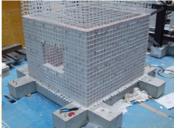
Gambar 1.6 Perkuatan dengan wiremesh (Sumber: Meguro, 2006)
