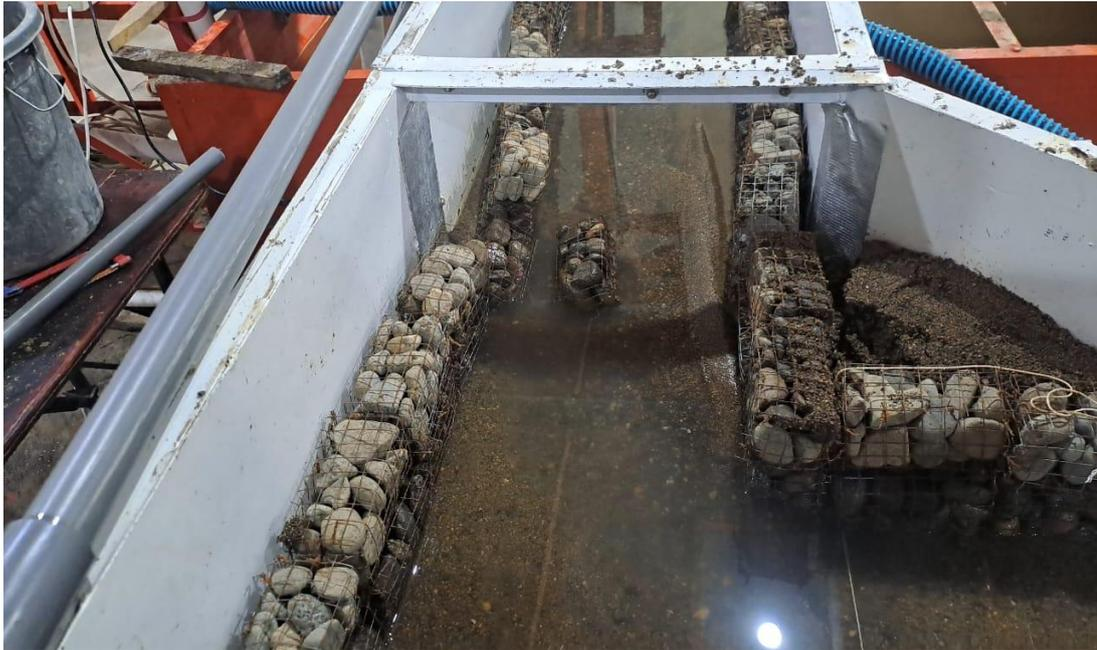
Gambar 3. 21 Pengujian dihentikan saat tebing runtuh
