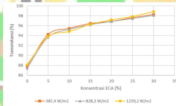
**Gambar 2. 19** Hubungan konsentrasi ECA terhadap transmittansi
