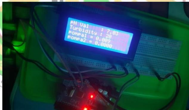
Gambar 4. 7 Pengukuran Pada Sensor pH
