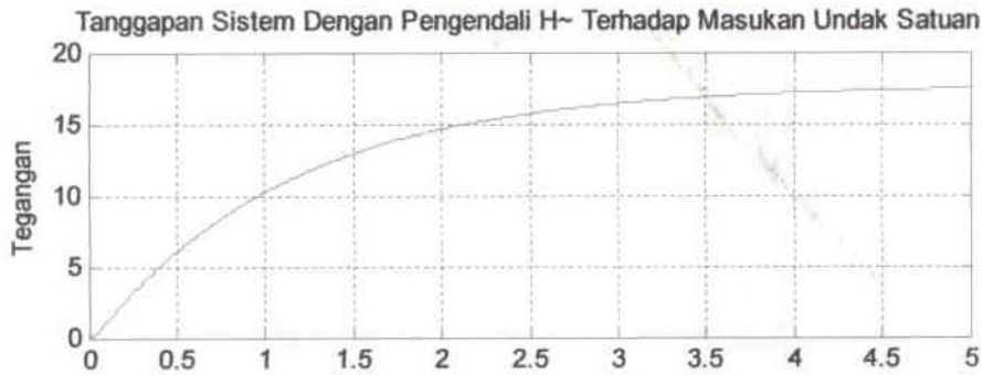
Gambar 4.9 Tanggapan Peralihan Sistem Lingkaran Terbuka dengan Metode H~ Optimal
