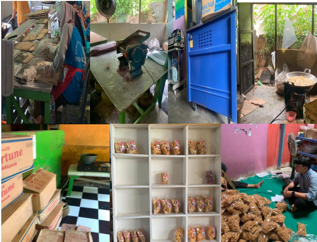
Gambar 1.2 Alat Dan Barang Tidak Sesuai Area Kerja dan Tidak Tersusun Rapi Serta Tidak Memiliki Label Penanda dan Ditumpuk
