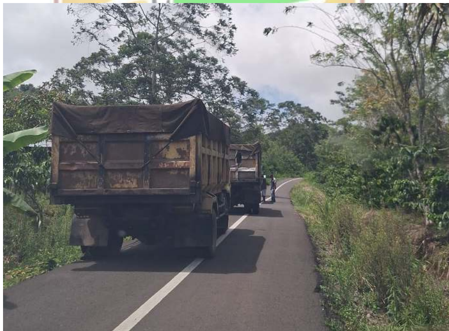
Gambar 4.11 Pengangkutan asphalt ditutup dengan terpal
