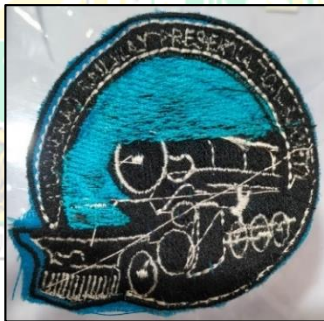
Gambar 1.4 Reject Warna Tidak Sesuai
