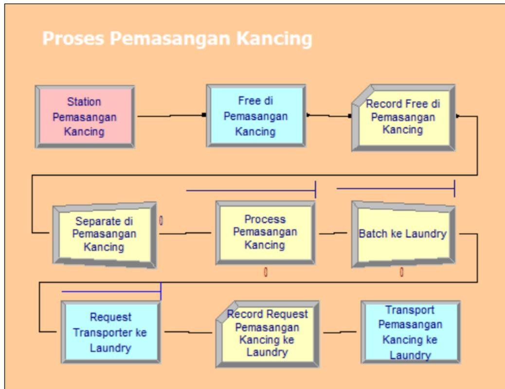
**Gambar 4.21** Rancangan Model Proses Pemasangan Kancing
